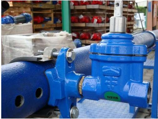
**Abraçadeira e válvula de ramal mostrando furo executado corretamente.**
